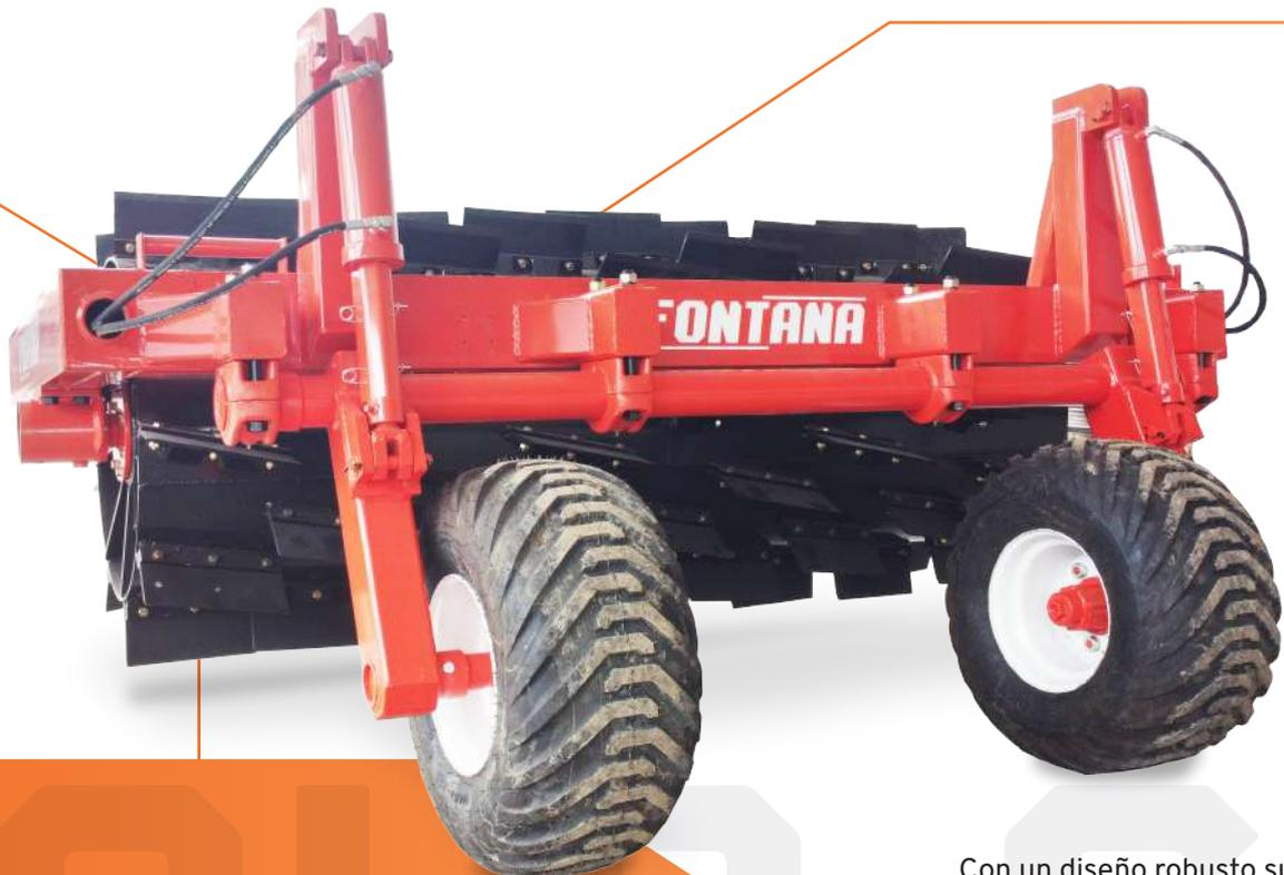
Con un diseño robusto su estructura tubular se encuentra construida de un 220 mm de alta resistencia, brindan calidad estructural y al mismo tiempo aumentan el peso del equipo.
