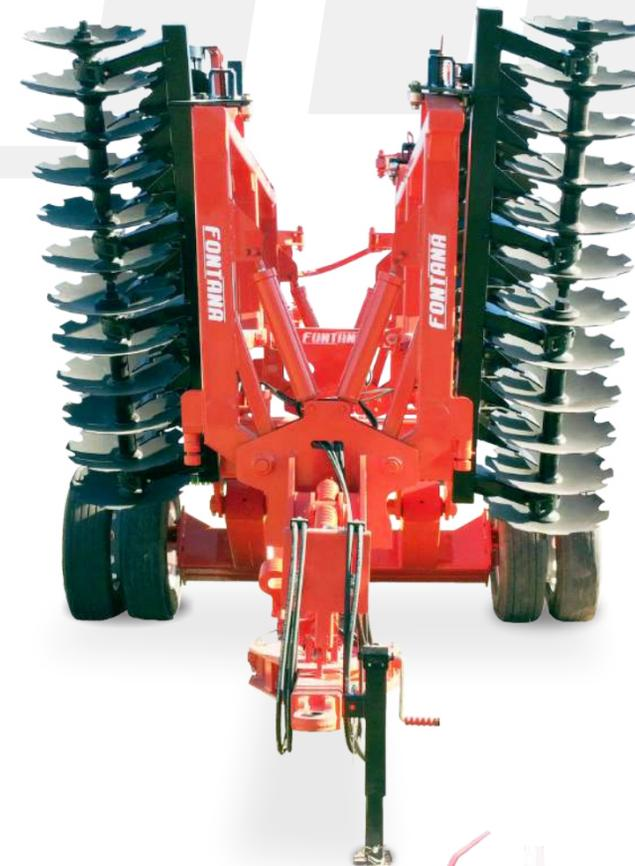
El plegado es mediante 4 cilindros hidráulicos otorgándole gran practicidad y un ancho de transporte de 3.50 mts. Llantas duales con cubiertas 295/80 x 22.5" le otorgan gran flotabilidad, estabilidad en el laboreo y seguridad en el transporte.
