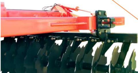
Las configuraciones a elegir pueden ser entre discos de 26" x 6 mm o 26" x 5 mm. y el espacio entre discos de 230 mm o 200 mm. Equipada con 16 cajas en baño de aceite y ejes de discos de 42 mm.
