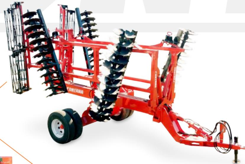
Los portadiscos están construidos en tubos conformados de 120 x 120 x 8 mm. el ángulo de ataque de los discos es regulable por puntos de 18° a 24° mediante una corredera con rodamientos permitiendo un ajuste rápido de acuerdo al trabajo a realizar.
